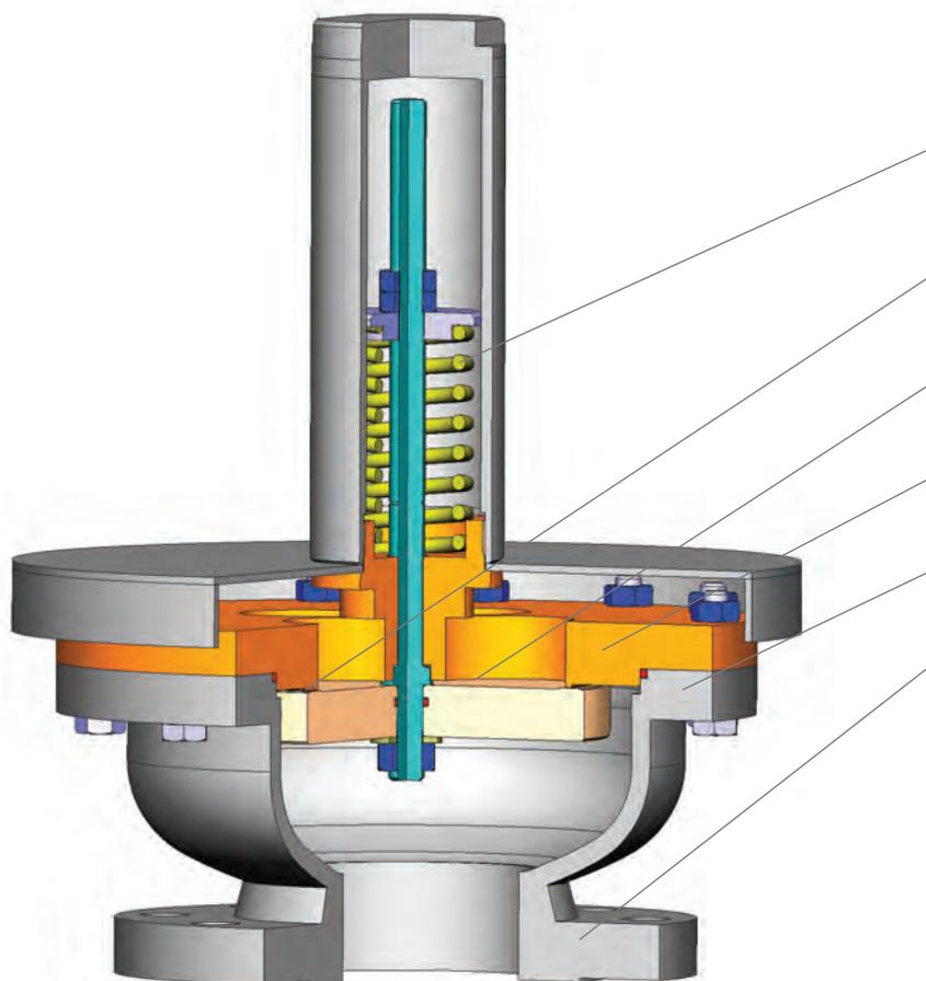
Витая пружина из легированной стали для обеспечения точной и повторяемой характеристики
